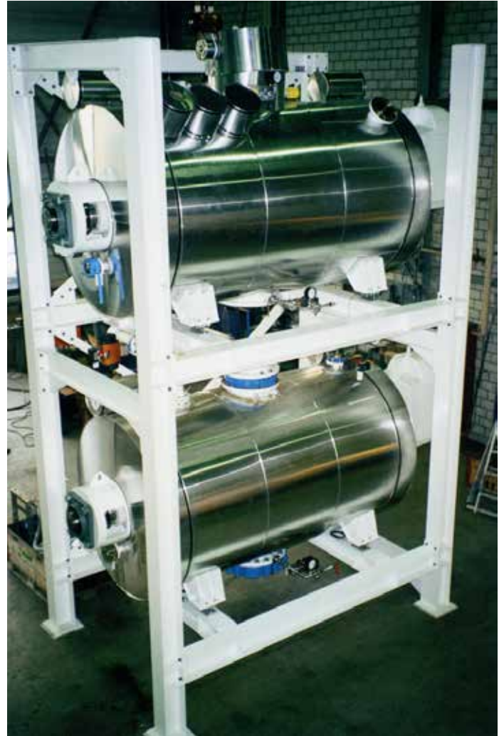
Turmkonstruktion mit Vakuum-Misch-Trockner VT (oben) und Vakuum-Misch-Kühler VK (unten)
