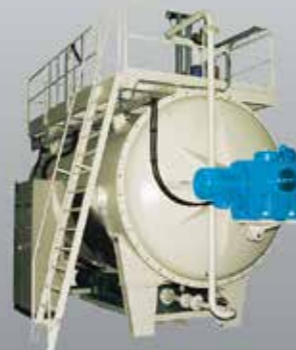
Vakuum-Grossmischer VGM für das Zusammenführen mehrere Kleinchargen
