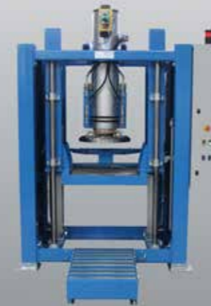
Fass- und Hobbockabfüllanlage FHA zur Abfüllung von mittel- bis hochviskosen Produkten
