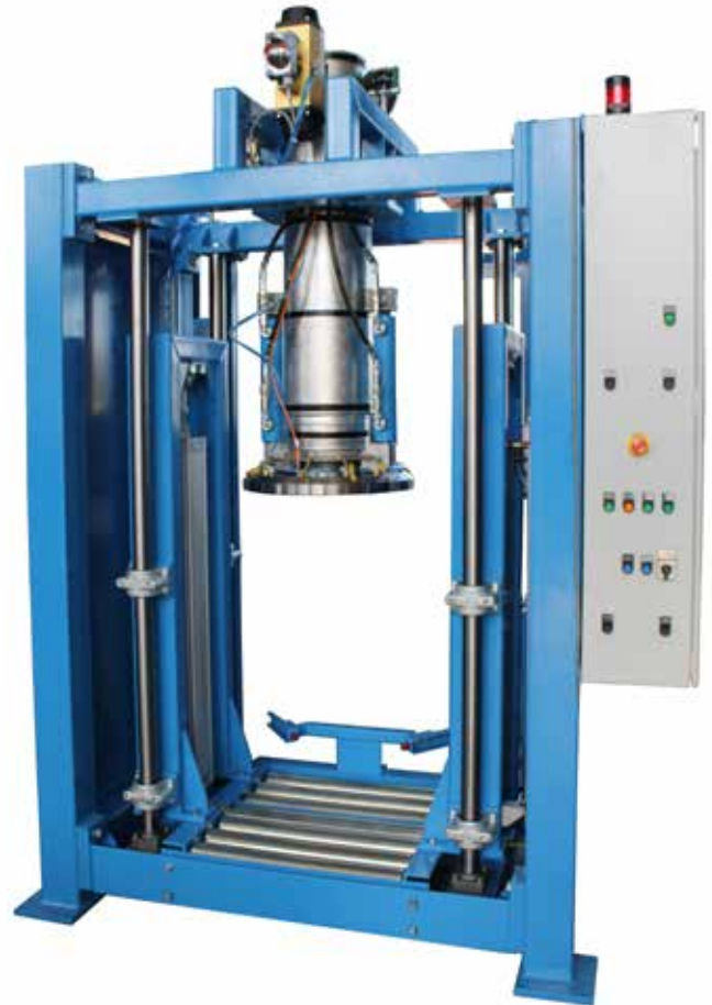
Einzelfassabfüllanlage mit hydraulischem Schnellwechselfiltersystem
